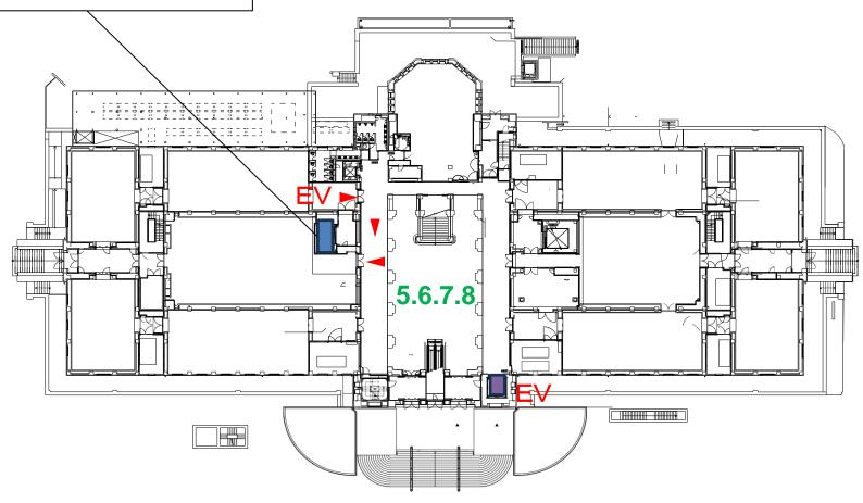
荷物用エレベーター 3階大型物品搬入専用  $W3000 \times D3000 \times H2500$ mm 人用エレベーター 地下1階~3階搬入 W1260 × D1330 × H2290mm
